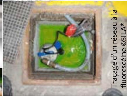
Traçage d'un réseau à la fluorescéine ©SILA\*
